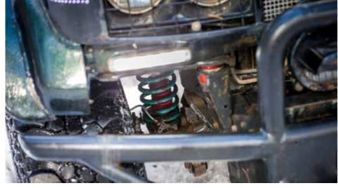
По подвеске конкретно этого автомобиля можно сказать, что тут впереди стоит подвеска Tough Dog. На задней оси стоят по два амортизатора AmadaXtreme с регулировкой усиления жёсткости на каждую сторону. Они, как положено, отрегулированы и работают в паре.
