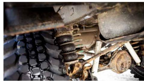
Управлять жесткостью подвески можно из салона. Автомобиль «залифтован» на 5 сантиметров, чтобы можно было установить колеса размером 36 дюймов. Дополнительно на заднюю ось установлена пневмоподвеска, которая позволяет регулировать угол горизонтального наклона и выправлять автомобиль. Данный автомобиль предназначен для перевозки большого количества грузов, поэтому и подвеске мы уделили особое внимание.
